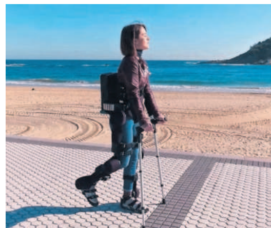
Hank lleva una batería y tiene una autonomía de cuatro horas.
