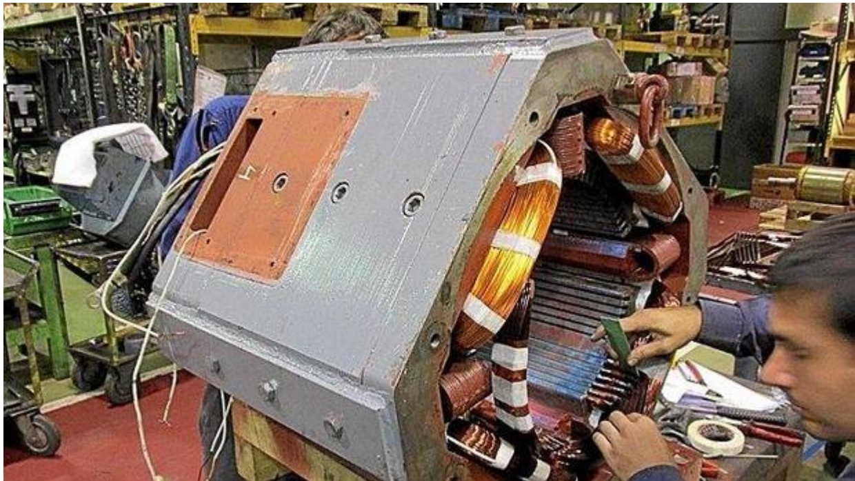
Un profesional de Motorlan durante la reparación de un motor industrial.
